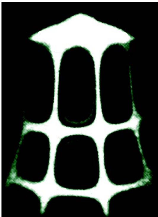
Figura 1. Ondas estacionárias de três dimensões num sino vibrando.
