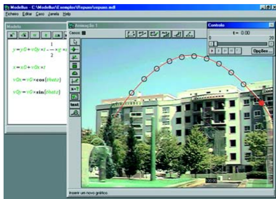
Figura 3. Avaliação de um modelo pela comparação entre a trajetória prevista pelo modelo e dados experimentais na forma de uma fotografia.
