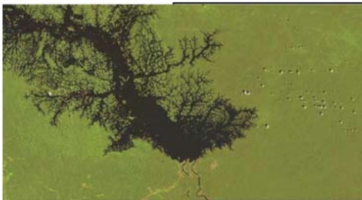
Figura 14. Imagem de satélite mostrando a área inundada de Balbina. São 2.360 km<sup>2</sup> de área inundada e capacidade instalada de apenas 250 MW (1,1 kW por ha de área inundada). Fonte da imagem: Embrapa (2007).
